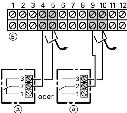
Entsprechende Brücke auf der Klemmleiste entfernen.
